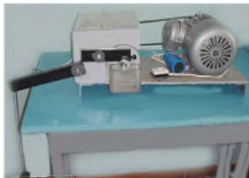
2-р зураг. Тосолгооны материалын тослох шинжийг судлах төхөөрөмж
